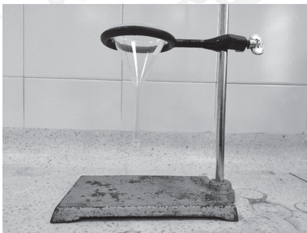
Figura 5. Montaje para realizar el proceso de filtración de pigmentos en metanol (elaboración propia).
