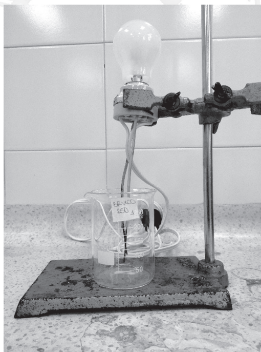
Figura 7. Montaje determinación de la conductividad (elaboración propia)
