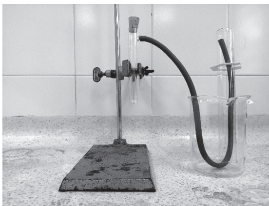
Figura 9. Monte para la determinación de CO 2 gas formado (elaboración propia)
