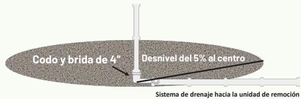
Finalizada la adecuación del terreno se debe realizar la instalación de una capa de plástico sobre la arena; posteriormente se puede instalar la estructura en platina que dará la forma circular del tanque; se extiende una espuma de Yumbolon a lo largo de la estructura para proteger la geomembrana y finalmente se instala la geomembrana. A continuación, se muestra la instalación paso a paso:
