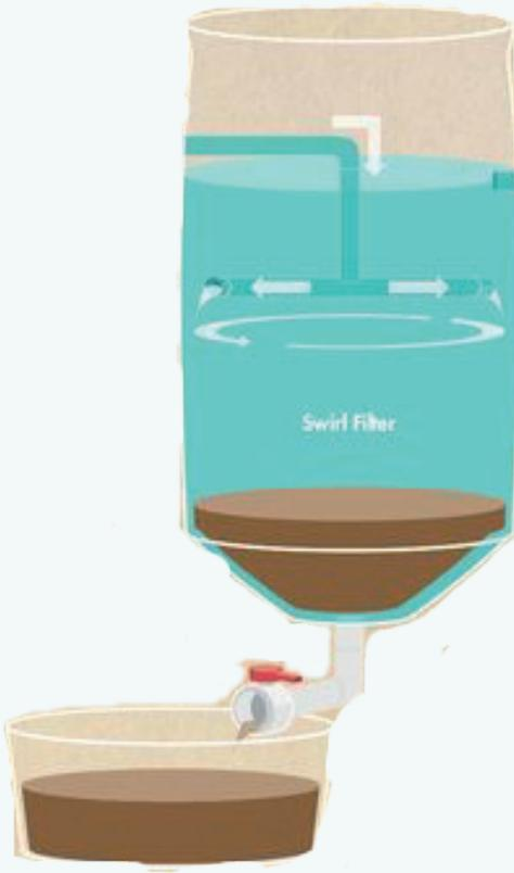
Por otro lado, la mineralización aeróbica se realiza principalmente con los sólidos sedimentables que se precipitan en la unidad de remoción de sólidos. Estos sólidos se deben extraer periódicamente y ser almacenados en otro componente independiente al sistema acuapónico, donde otras bacterias heterótrofas y con presencia de oxígeno degradan los sólidos y liberan otros nutrientes que pueden ser asimilados por las plantas.
