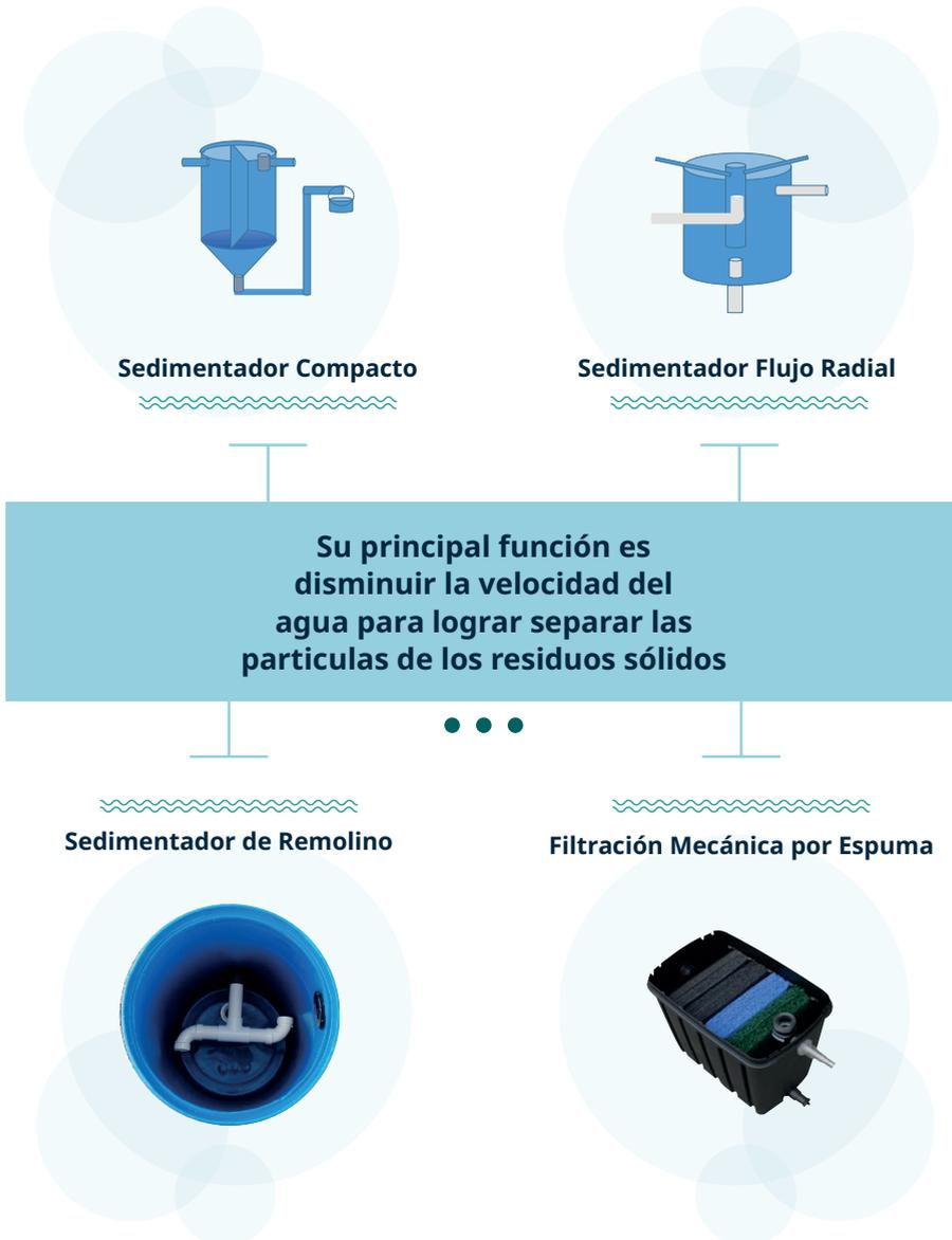
**Figura 3.** Tipos de sedimentadores: Compacto, flujo radial, de remolino, de filtración mecánica por espuma
