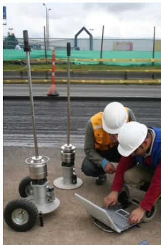
El equipo está equipado con una celda de carga de precisión que mide la fuerza de impacto que produce el peso de caída, y con un geófono de precisión (sensor de velocidad sísmica) que mide la velocidad con que se deforma la capa evaluada a causa del impacto producido por la carga. El geófono está en contacto directo con el material de la capa a evaluar a través de un orificio en el plato de carga, que permite obtener mediciones más precisas.
