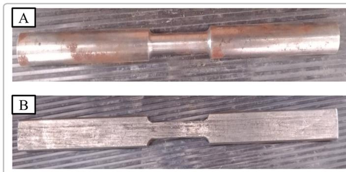
**Figura 15.** Probetas para el ensayo a tracción: A: cilíndrica y B: sección rectangular.
